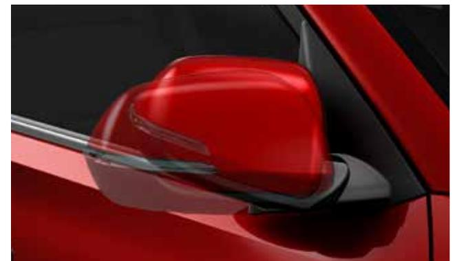
> Espejos exteriores eléctricos con señal de giro
